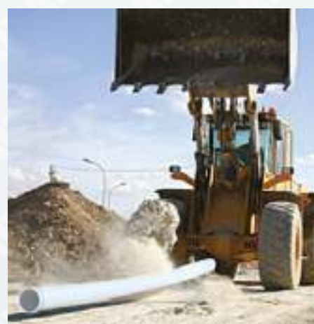
Tras el impacto de una piedra de 500 kg de peso desde una altura de 3 m, la tubería TOM by RIVAL permanece inalterada.
